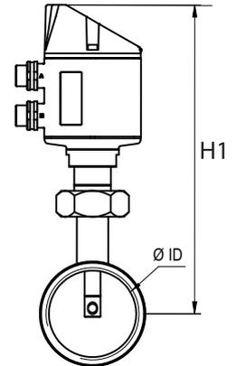
Durchflussmengenmesser inkl. Messstrecke mit Flanschanschluss (DIN EN 1092-1)
