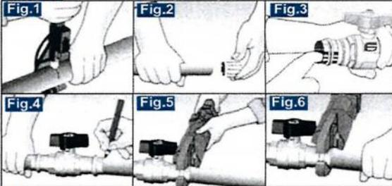
**Fig. 1** Tagliare il tubo, ad angolo retto • Cut the pipe at right angle. • Couper le tube à angle droit. • Abschneiden das Rohr um rechte Ecke • Cortar el tubo en ángulo recto.
